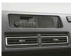
センターエアコンレジスター (シルバー加飾) メッキエアコンレジスターノブ (センター)
